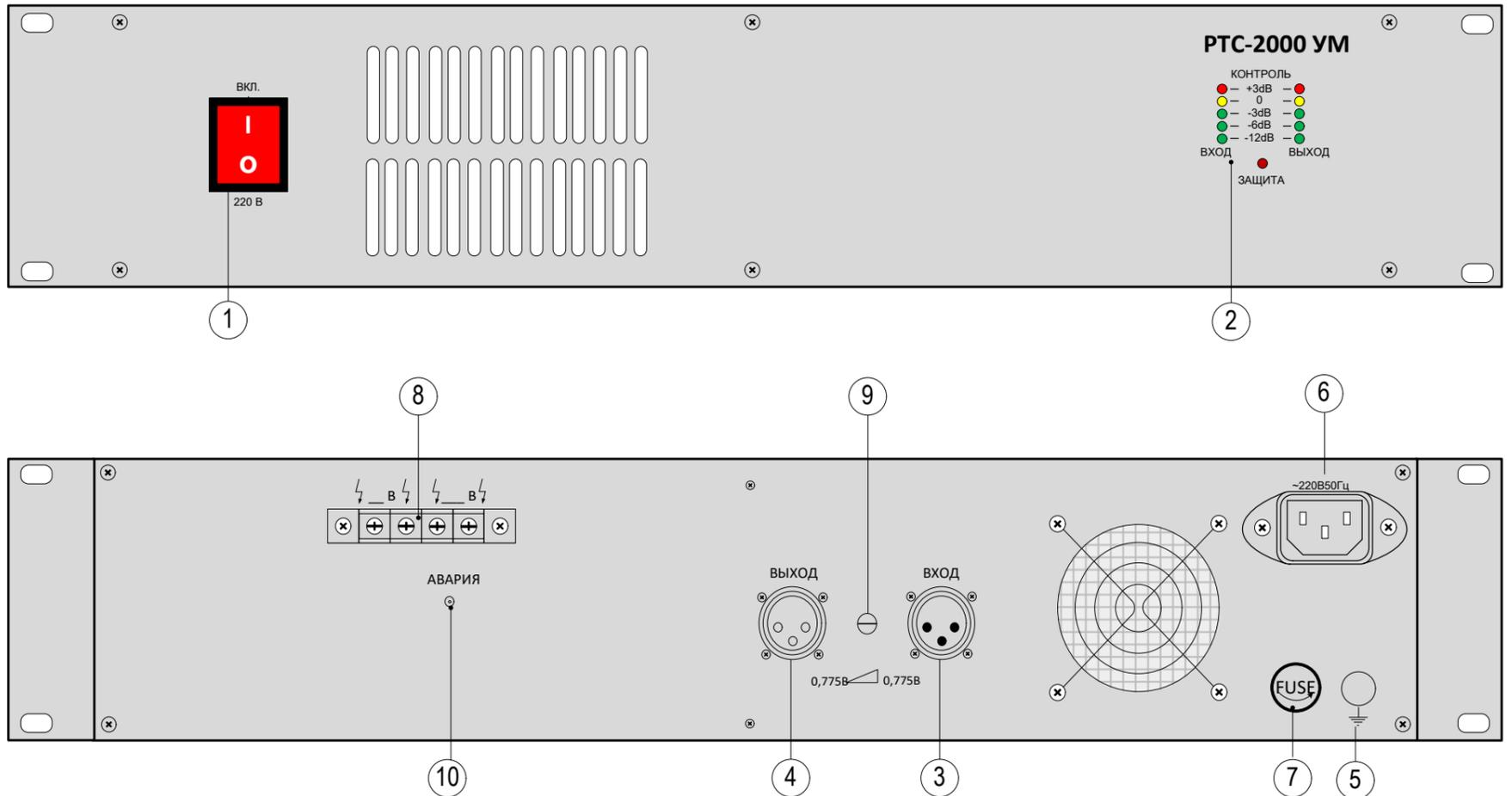
1. ВЫКЛЮЧАТЕЛЬ СЕТЕВОГО ЭЛЕКТРОПИТАНИЯ
