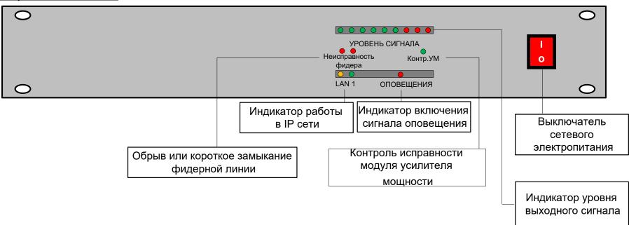
На передней панели усилителя-коммутатора расположены:
